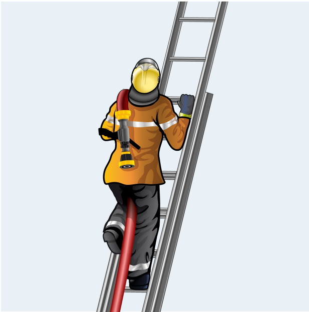
Modo di salire su una scala con una condotta di spegnimento
