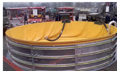
Vasca rigida composta da elementi in alluminio, per es. 50'000 l
