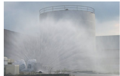
Abbattimento di gas e vapori con l'aiuto di uno schermo d'acqua
