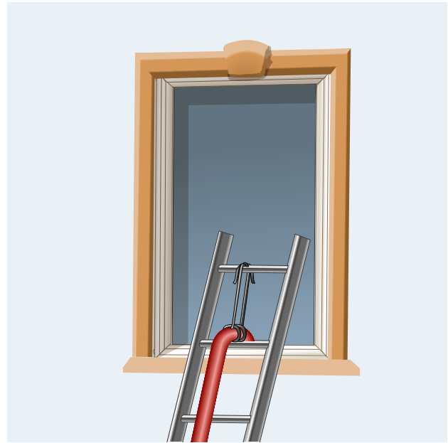
Far passare la condotta tra i pioli e assicurarla
